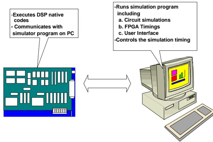
Fig. 6 Test Bed System
