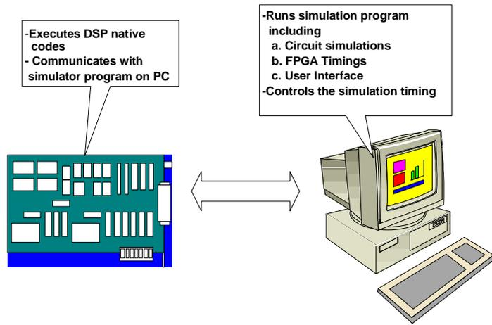
Fig. 6 Test Bed System
